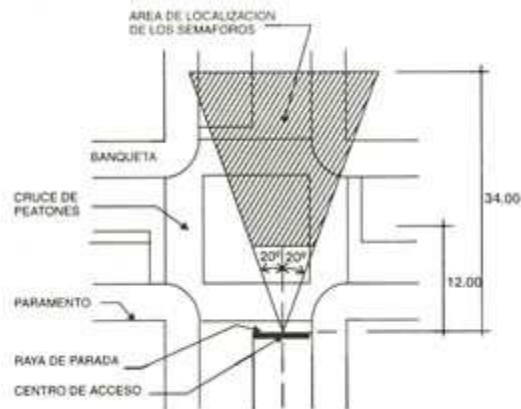
FIG. 5.3 LOCALIZACION DE LAS CARAS DEL SEMAFORO EN EL LADO MAS LEJANO DEL ACCESO DE LA INTERSECCION
