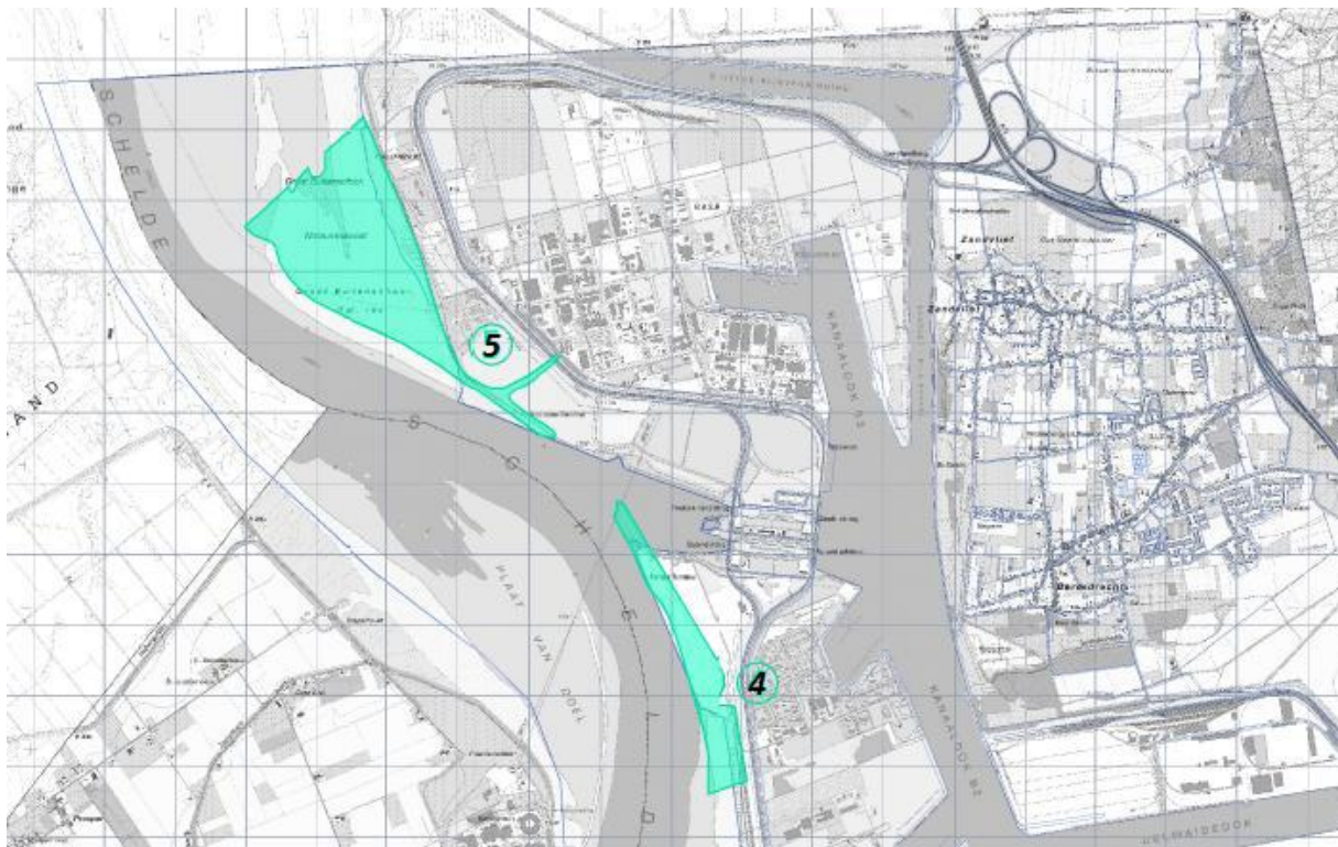
Figuur 3-11: Vergelijking achtergrondkaart (2005) met in de het groen aangegeven schorgebieden (1960), ingrepen bij de Europaterminal en Zandvliet. Bron: Consortium Deltares-IMDC-Svasek-Arcadis (2013b).
