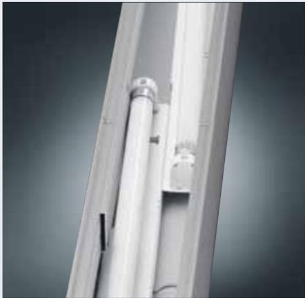
Die vollkommen homogene Ausleuchtung des Lichtkanals wird durch diagonal versetzte Fassungspositionen erreicht. Dunkelstellen, die sich bei einer geradlinigen Anordnung durch Fassung und Lampensockel ergeben, gehören somit der Vergangenheit an.
