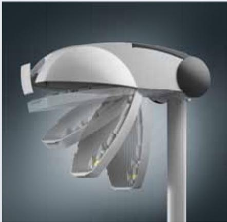
Das austauschbare LED-Modul vereint unterschiedliche Funktionen. Das Gehäuse aus Aluminiumdruckguss sorgt für ein optimales Thermomanagement und somit für die lange Lebensdauer der LED. Die 48 High-Power-LED sind jeweils mit einem Linsensystem versehen, das für eine optimale Lichtverteilung sorgt. Die eingedichtete plane Abdeckscheibe verhindert nicht nur, dass Licht in den Himmel abstrahlt, sondern trägt zudem zur Einhaltung der hohen Schutzart IP66 bei.
