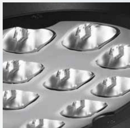
**Optisches System** bestehend aus zwölf metallisierten Kunststoffreflektoren, satiniert. Mit minimalisierter, computeroptimierter Reflektorkontur zur Erzeugung einer anwendungsbezogenen, asymmetrisch breit strahlenden Lichtstärkeverteilung.
