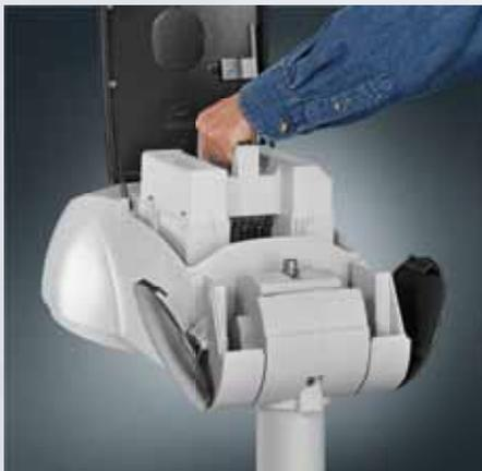
Die beiden korrosionsbeständigen Verschlüsse der Lumega ermöglichen einen werkzeuglosen Zugang zum IP66-Anschlussraum der Leuchte. Der Verschlussdeckel ist arretierbar und gegen das Herunterfallen gesichert. Der werkzeuglos herausnehmbare E-Block beinhaltet die benötigten elektrischen Komponenten. Elektrische Steckverbindungen und mechanische Justierungen erleichtern die Handhabung.
