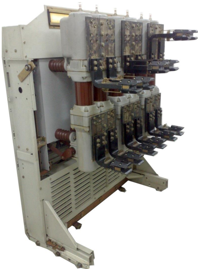
AEG-Schaltwagen mit ölarmer Leistungsschalter AEG-switch truck with MOCB
