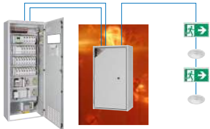
Elektroverteiler mit Funktionserhalt
