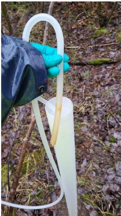
Figur 9. Grundvattenrör i provpunkt 22E09. Slang från förra provtillfället med en rostfärgad utfällning.
