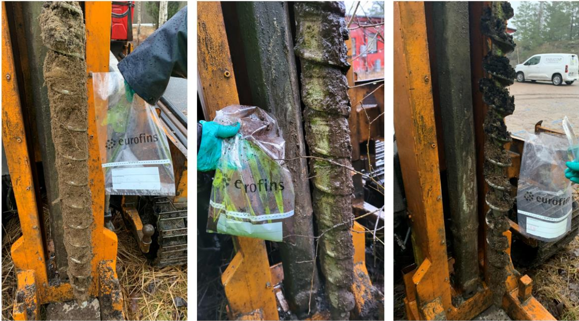
Figur 8. Från vänster: 23E22 0,0-1,0; 23E19 1,0-2,0; 23E16 0,0-1,0. De vanligast jordarterna visas i de tre bilderna, sandig silt/ siltig sand i 23E22 och 23E19, mulljord samt fyllnadsmaterial (sandigt grus) i 23E16.
