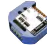
Der Etagen-Videoumschalter dient zur gezielten Umschaltung zwischen Etagen-Video-Außenstation und Haupt-Video-Außenstation auf eine Video-Innenstation. Er ist nur in Verbindung mit einem Video-signalverteiler zulässig.
