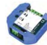
Für die Anschaltung von Kameras anderer Hersteller an TCS-Videoanlagen. Der Videozweidrahtsender wandelt das FBAS-Signal (75 Ohm) der Kamera zur Übertragung in ein 2-Draht-Signal um.
