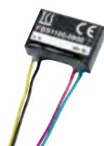
Für die Anbindung von Sensoren z. B. Lichtschranken, Dämmerungsschaltern an TCS-Außenstationen. Für die Übertragung zusätzlicher Schaltfunktionen z. B. für Garagentor- und Rollladensteuerungen in Verbindung mit BRE2-xx. Der Sensor ist nicht geeignet für Anlagen zum Betreten Wohnen bzw. mit Sonderruffunktion.
