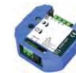
Für das Wandeln eines eingehenden symmetrischen Video signals (100 Ohm 2-Draht-Leitung bis ca. 1.000 m) in ein asymmetrisches Video signal (75 Ohm-Koaxialkabel). Das Koaxialkabel kann mittels BNC oder Chinch-Verbinder an alle 75 Ohm Videoeingänge von z. B. TV, Videorecorder und Monitore angeschlossen werden. Ein Abgleich zur Optimierung des ausgehenden Video signals ist möglich.
