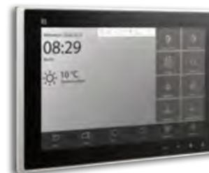
**Variable Anordnung folgender Funktionstasten:** gezielte Kameraauswahl, Ruftonabsteller, Rufumleitung, Türöffner, Zentral AN, Zentral AUS, 20 Internrufe, Türöffnerautomatik, Lichtschaltfunktion, Aufzugsfreigabe. Weitere 20 Schaltfunktionen sind individuell konfigurierbar. (Garagentorantrieb, Torantrieb, Außenlicht...)
