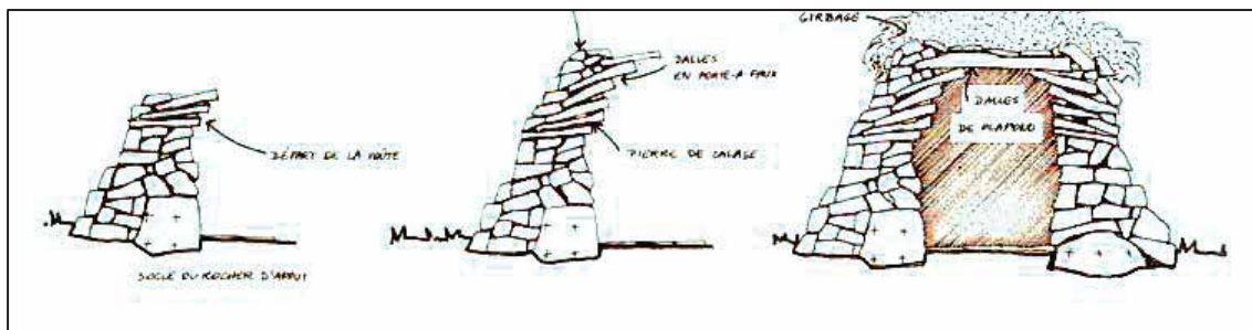
Figura 11. Representació de l'alçat de la canana d'un orry (Guillot, 2012).
