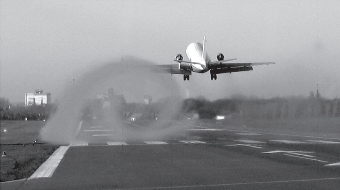
*Wirbelschleppen bei einem Flugzeugstart*
