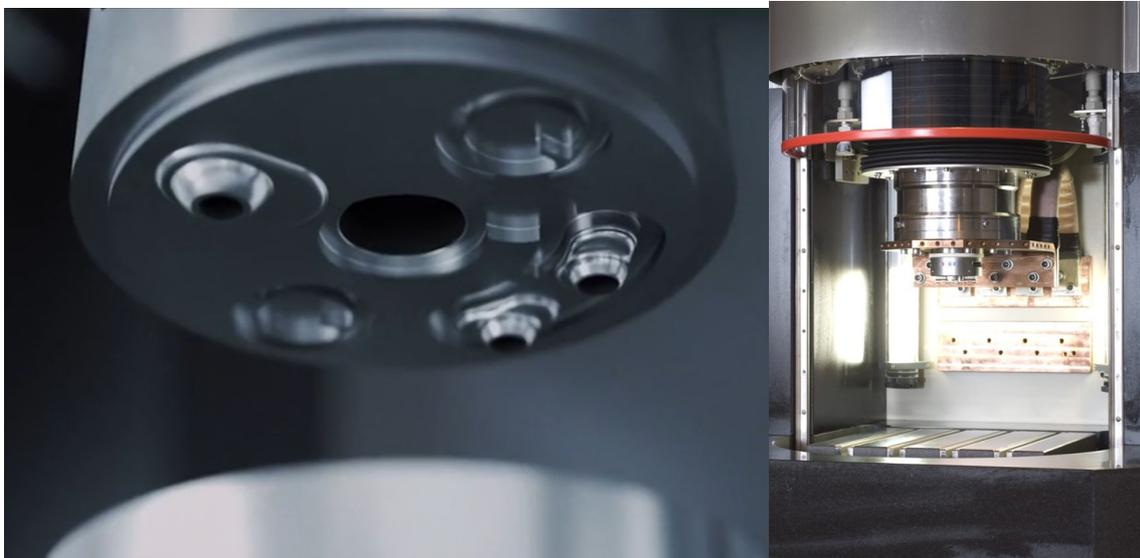
Darstellung einer Elektrode (=Werkzeug) links oben im Bild und ein Bild des Arbeitsraums einer PECM-Anlage im Bild rechts
