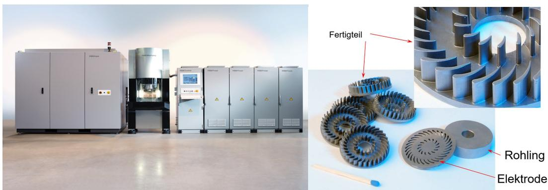
Die PECM-Anlage der Tec Man Saar GmbH (links) sowie die Zuordnung von Werkzeug, Rohling und Fertigteil
