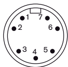
Abb. 5: X18: Eingang Messwertgeber (male; Blick auf den Messwertgeber)
