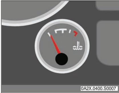
Die Temperaturanzeige arbeitet bei eingeschalteter Zündung.
