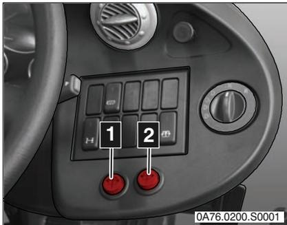
Über die Türtaster, hier beispielhaft dargestellt, unterhalb der Schaltergruppe rechts, lassen sich die vordere Schwingtür **1** und die hintere Schwingtür **2** bei stehendem Fahrzeug und eingeschalteter Zündung öffnen und schließen.
