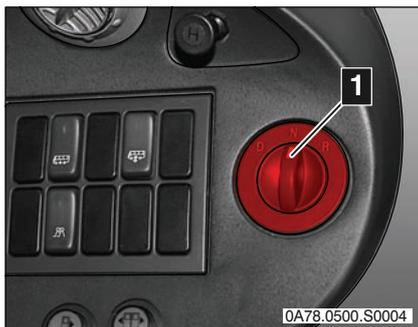
Die Getriebeelektronik des automatischen Schaltgetriebes schaltet die Gänge je nach aktueller Anforderung und Fahrzustand selbsttätig.
