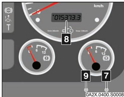
Im Tachometer ist die Tages- und Gesamtkilometeranzeige integriert. Mit Hilfe der Taste unterhalb der Luftdruckanzeiger kann die Anzeige gewechselt werden.
