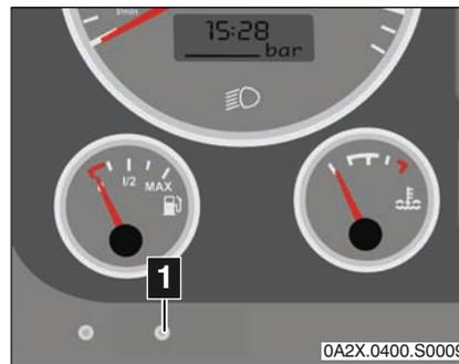
Die Uhrzeit wird im 24-Stundenformat, die Außentemperatur in °C oder °F, je nach Sonderausführung, angezeigt.
