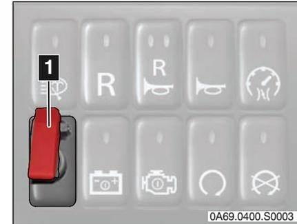
Der NOT–AUS–Schalter **1** befindet sich auf der Hauptschalttafel oder auf einer zusätzlichen frei angeordneten Schalterleiste. Bild ist beispielhaft.
