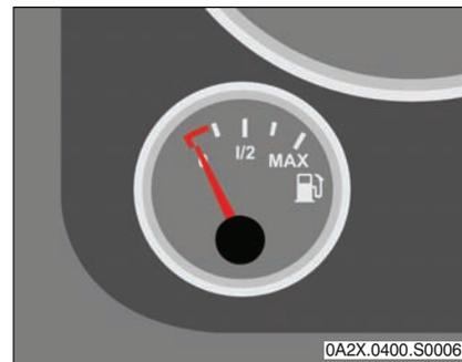
Die Kraftstoff-Vorratsanzeige arbeitet bei eingeschalteter Zündung. Nach kurzer Zeit erreicht die Nadel die korrekte Anzeigestellung.
