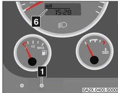
Mit der Taste unterhalb der Kraftstoffvorratsanzeige lässt sich die Helligkeit der Instrumente und des Fahrerdisplays einstellen.
