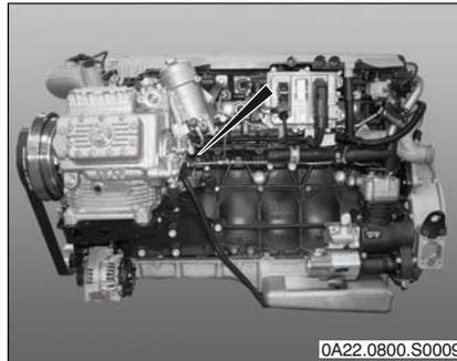
Das Motorschild befindet sich am Motorblock in Höhe des 1. Generators. Es gibt Auskunft über Motortyp und Motornummer.
