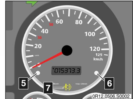
Der Tachometer gibt Auskunft über die aktuell gefahrene Geschwindigkeit. Das Display unterhalb der Tachometernadel zeigt die Tages- bzw. Gesamtkilometer an.
