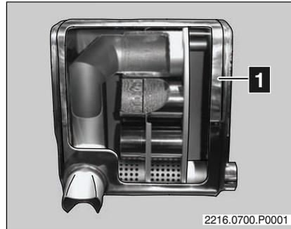
Der PM-KAT® **1** regeneriert sich selbstständig. Selbst bei hoher Rußbelastung steigt der Abgasgedruck kaum an und negative Auswirkungen auf die Motorleistung und den Treibstoffverbrauch bleiben aus.
