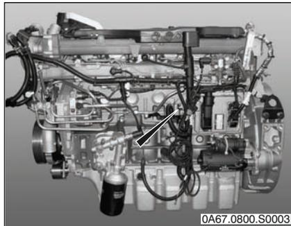
Das Motorschild ist links vom Motorsteuergerät angebracht. Es gibt Auskunft über Motortyp und Motornummer.
