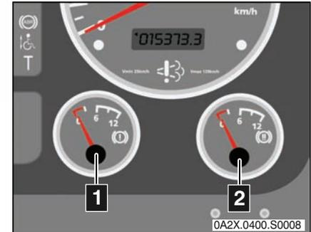
Die beiden Vorratsdruckanzeiger zeigen den im jeweiligen Bremskreis anliegenden Vorratsdruck an.
