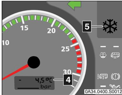
Bewegt sich die Außentemperatur zwischen  $-5$  und  $+4$  °C und die Fahrgeschwindigkeit ist  $> 3$  km/h, wird die Uhrzeitanzeige verdrängt und die aktuelle Außentemperatur **4** wird angezeigt.
