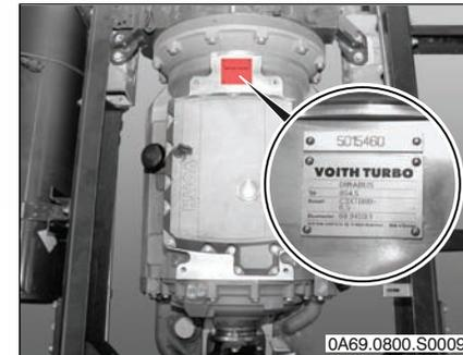
Das Typschild des Getriebes ist oben mittig am Getriebegehäuse angebracht. Stücklistennummer, Getriebetyp und Seriennummer sind darauf abzulesen. Bild ist beispielhaft.
