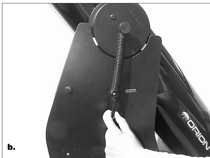
Figura 8. (a) Para acoplar el resorte a la base, agarre el lazo de extracción con el dedo índice y tire del resorte. (b) Mientras tira hacia abajo, deslice el anillo del extremo del resorte sobre la cabeza del perno y en la parte estrecha del separador de nylon. A continuación, suelte el lazo de extracción.
