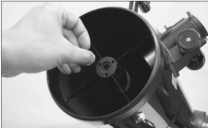
Figura 15. Ajuste la inclinación del espejo secundario, aflojando o apretando los tres tornillos de ajuste de alineación con una llave hexagonal de 2 mm.
