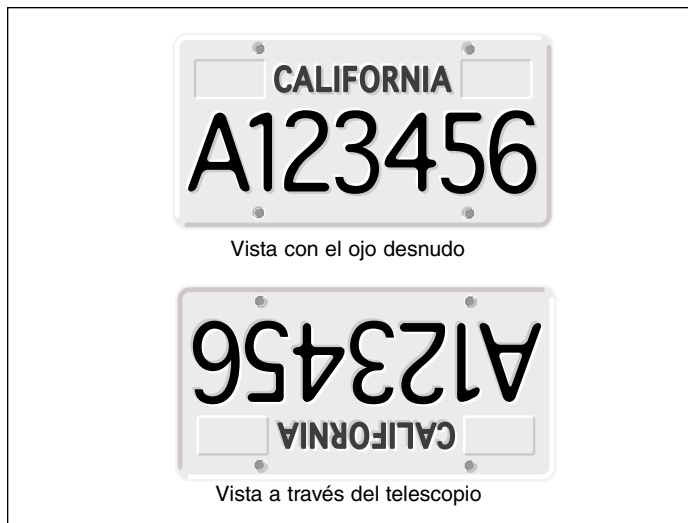
Figura 11. La vista a través de un telescopio reflector está invertida.
