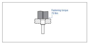
Fig. 5: Mounting example of threaded flange »F«, »M«, »S«, »W«
