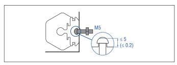
Fig. 11: T-slot nut M5 (part no. 401 602)
