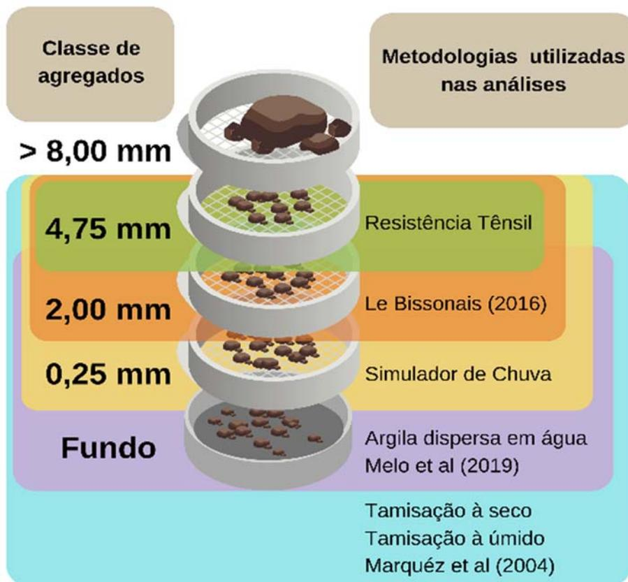
**Figura 2.** Separação prévia das classes de agregados requerida pelas metodologias utilizadas no estudo antes da realização das análises referente a cada metodologia.
