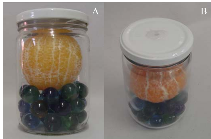
Figura 4 – Armazenamento dos frutos em frascos herméticos contendo bolas de vidro para diminuir o espaço livre dentro dos mesmos e concentrar os gases produzidos pelos frutos, para facilitar a quantificação da produção de etileno (A). Detalhe do septo de silicone na tampa pelo qual eram coletadas amostras de gases para quantificação da atividade respiratória ( \text{CO}_2 ) e etileno (B)
