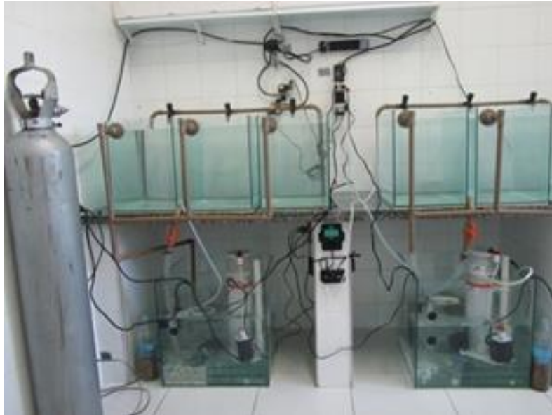
Figura 3.1. Sistema de aquários utilizados nos experimentos: tanques experimentais de circulação na parte superior e sumps na parte inferior.
