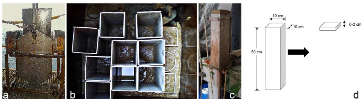
Figura 24: Equipamento e procedimentos de coleta: a) box core utilizado na coleta; b) subamostrador com dimensões de 10 cm x 10 cm x 50 cm; c) fatiador da amostra coletada no subamostrador; e d) desenho esquemático da subamostragem (0-2 cm).
