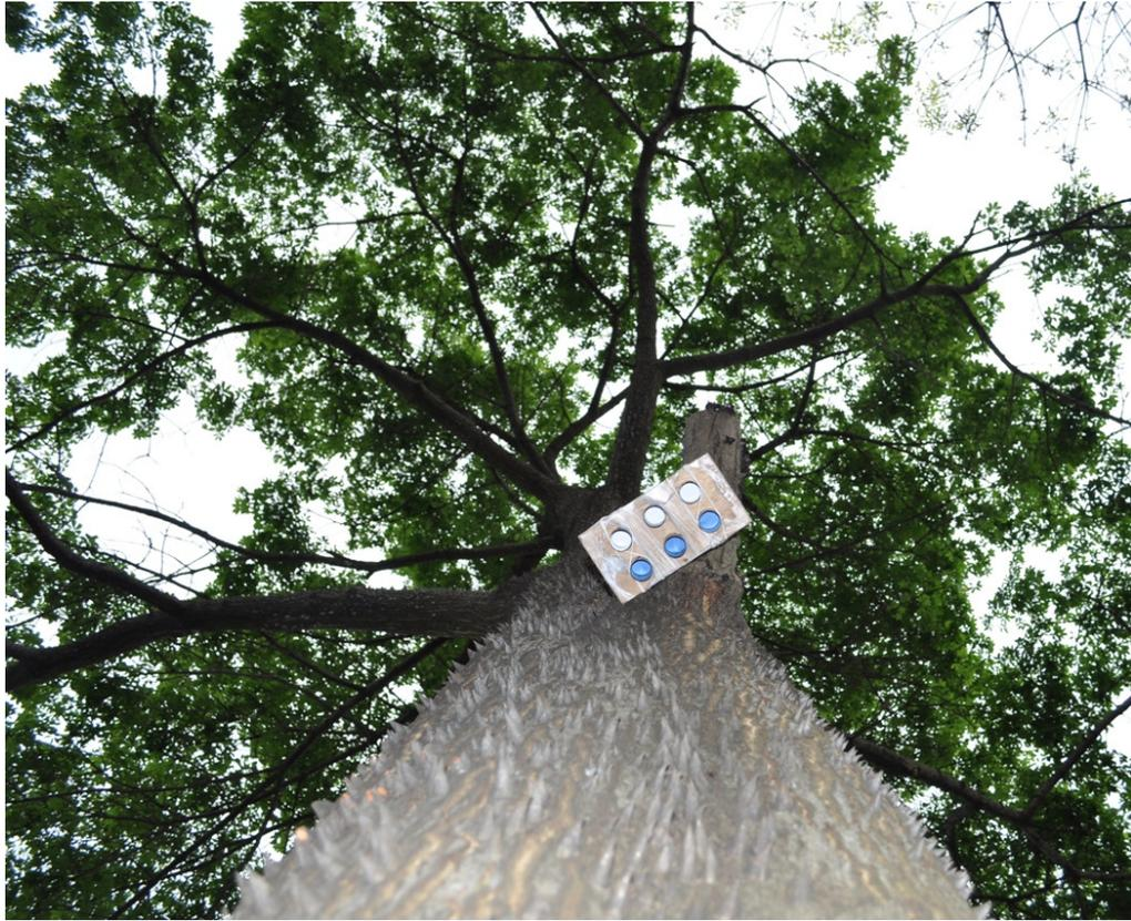
Figura 16 – Filtro passivo de O<sub>3</sub> e NO<sub>2</sub> na árvore ao lado do canteiro de borda do Parque Cidade de Toronto.
