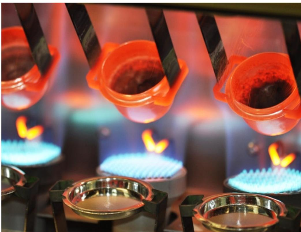
Figura 14 – Imagem do processo de preparação das pastilhas fundidas (FGD) para análise dos elementos traços no solo dos parques estudados.
