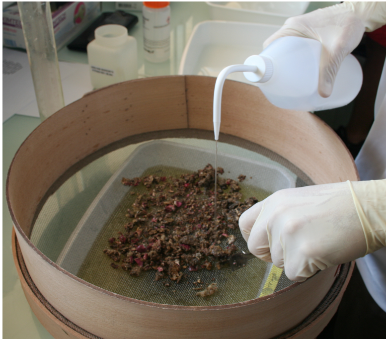
Figure 1.4. – Tamisage d'un échantillon de coralligène.
