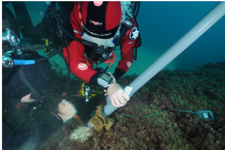
Figure 1.2. – Echantillonnage réalisé à l'aide d'un aspirateur sous-marin et d'un burin.
