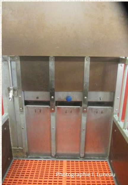
Photographies du dispositif de cages automatiques (vue complète en haut) utilisées pour les tests de choix alimentaire et de conditionnement avec ratio progressif sur le projet SLK. En bas à gauche : vue de l'intérieur avec les trois auges : fermées et le bouton presseur bleu au dessus de l'auge centrale. En bas à droite le système d'approvisionnement à l'extérieur (derrière) la cage.
