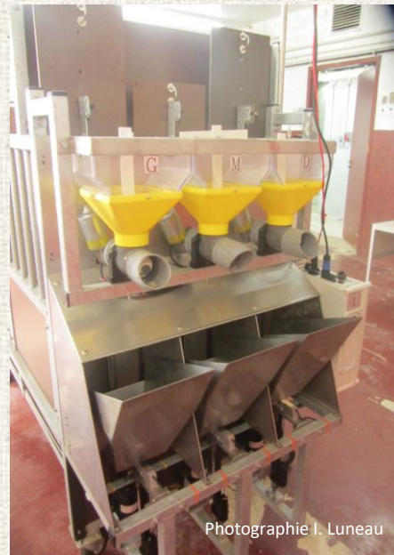
Photographies du dispositif de cages automatiques (vue complète en haut) utilisées pour les tests de choix alimentaire et de conditionnement avec ratio progressif sur le projet SLK. En bas à gauche : vue de l'intérieur avec les trois auges : fermées et le bouton presseur bleu au dessus de l'auge centrale. En bas à droite le système d'approvisionnement à l'extérieur (derrière) la cage.
