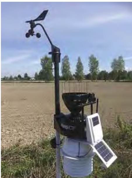
Kuva 2. Davis Vantage Pro2 -sääaseman ISS-yksikkö ja anemometri aurinkokennoineen (Kuva: Juha Tiainen 2019).
