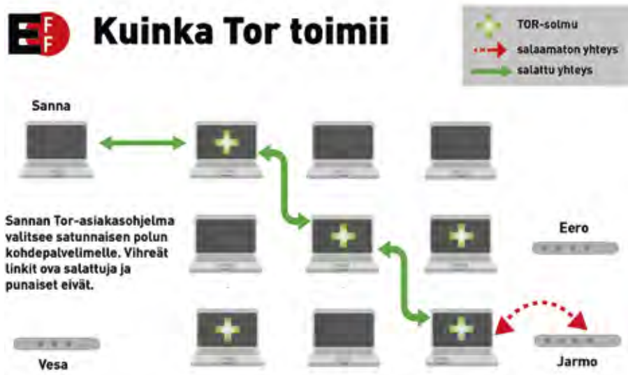
Kuva 1. Tor-verkon toimintaperiaate visualisoituna (Kuva: Wikimedia Commons, Electronic Frontier Foundation (EFF) [CC BY 3.0 ( https://creativecommons.org/licenses/by/3.0/ )]).
