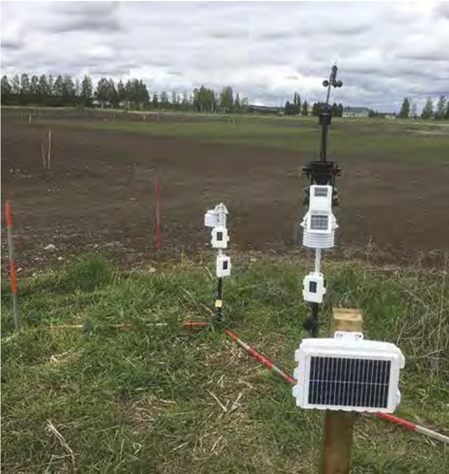
Kuva 3. Sääseman layout. Etualalla datan lähetyspäätte akkuvarmistuksineen. Akku latautuu kääntyvän kannen aurinkokennon avulla. Lähetin siirtää antureiden keräämän säädätän matkapuhelimen -3G-verkkoon ja internetin pilvipalveluun. (Kuva: Juha Tiainen 2019.)
