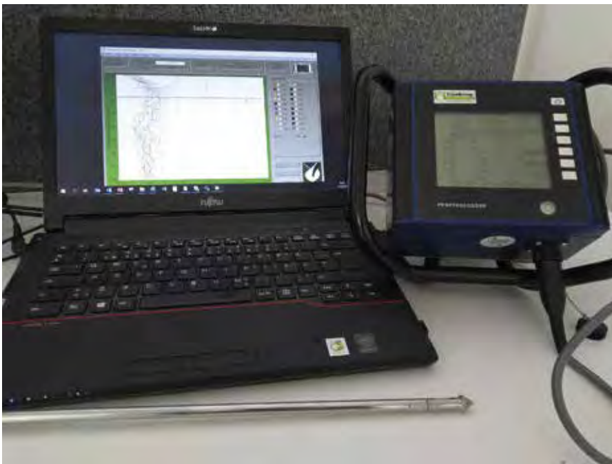
Kuva 1. Oikealla penetrometri (ilman piikkiä) ja osa piikistä etualalla. Mittaustulokset voidaan lukea joko mittarin näytöltä tai PenetroViewer-ohjelmasta (kuvissa eri datat näytöillä). (Kuva: Jussi Esala 2019.)
