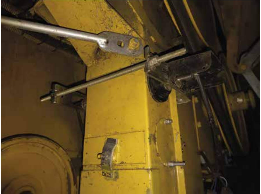
Kuva 5. Koulutilan puimurin valoverhoon perustuva sadonmittausanturi (Kuva: Jussi Esala 2017).
