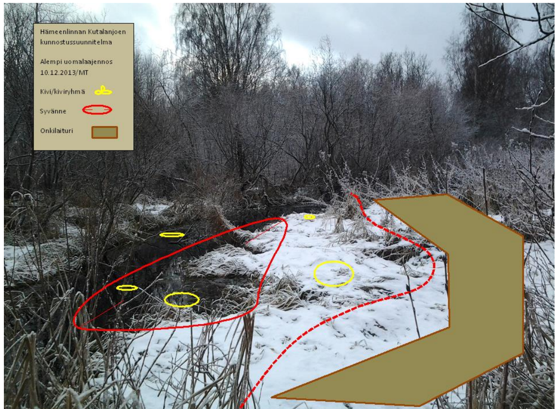
Kuva 21. Alempi nykyisen ja vanhan uoman risteyskohtaan kaivettava uomalajennos.
