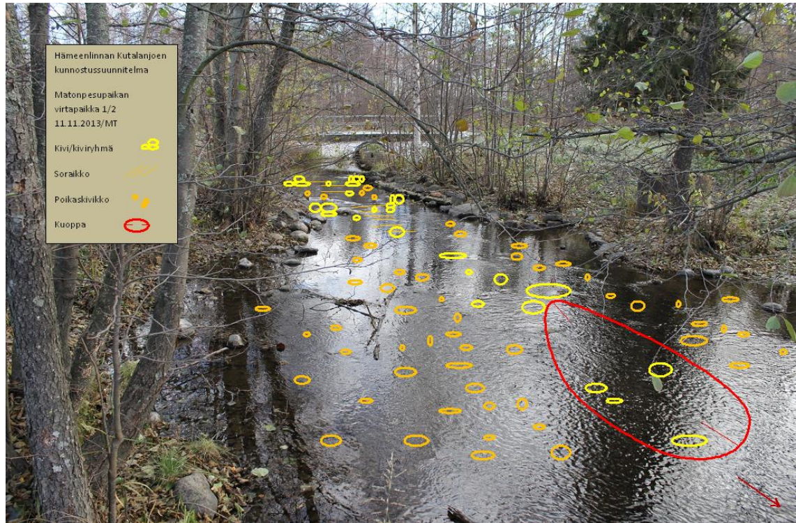
Kuva 13. Matonpesupaikan virtapaikan ylempät suunnitellut kunnostustoimenpiteet.
