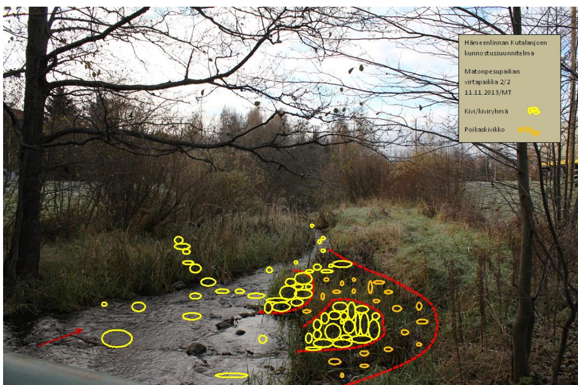
Kuva 14. Matonpesupaikan virtapaikan alemmat suunnitellut kunnostustoimenpiteet.
