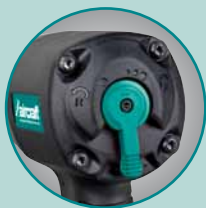
Anzugsmoment 3-stufig verstellbar
