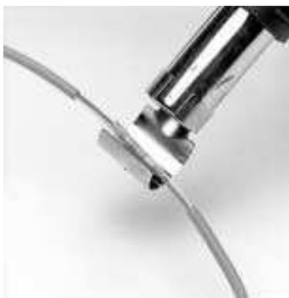
Spleißstelle mit Heißluftgebläse erwärmen, bis die Isolierhülle schrumpft und der Kleber an den Enden austritt. Durch das Fließen des Klebers werden alle Hohlräume ausgefüllt und die Spleißstelle ist zuverlässig versiegelt.
