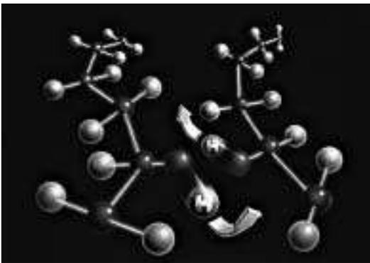
Die Forschung im Bereich der Bestrahlung chemischer Stoffe führte zur Entdeckung, daß bestimmte Thermoplaste unter dem Einfluß energiereicher Elektronenbestrahlung durch Abspaltung von Wasserstoffatomen chemische Bindungen zwischen benachbarten Molekülen herstellen.
