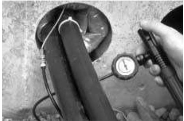
Nach Entfernen des Füllschlauches verhindert das automatische Gel-Ventil-System Druckverluste.
