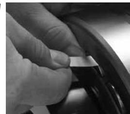
图 14. 在轴承安装之前测量径向游隙
