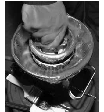
图 21. 可以用手轻松涂抹润滑脂。 图 22. 机械式润滑脂涂抹器。
