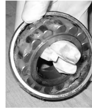
图 21. 可以用手轻松涂抹润滑脂。 图 22. 机械式润滑脂涂抹器。
