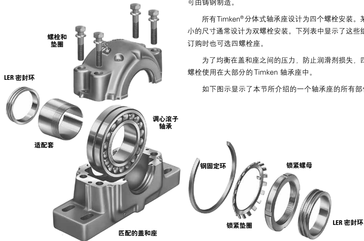
图 48. 铁姆肯公司带座调心滚子轴承剖析图，图示为锥孔调心滚子轴承、紧定套、锁紧螺母和锁紧垫圈、固定环和三重迷宫密封。还可见形成撬杠工具槽的盖和座中得凹口及支点。
