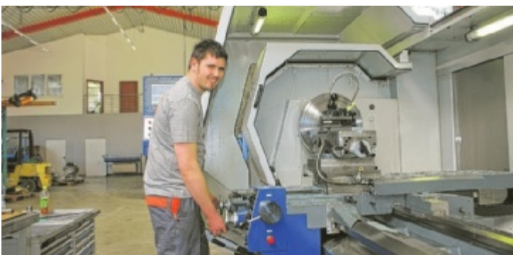
Mitarbeiter David Jungwirth bedient die zyklusgesteuerte Drehmaschine.
