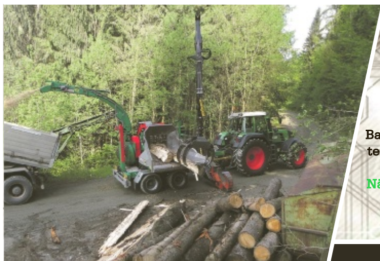
Fahrzeug: Fendt 930 mit Mus-Max WT 9 XL Hackmaschine mit Spaltzange.
