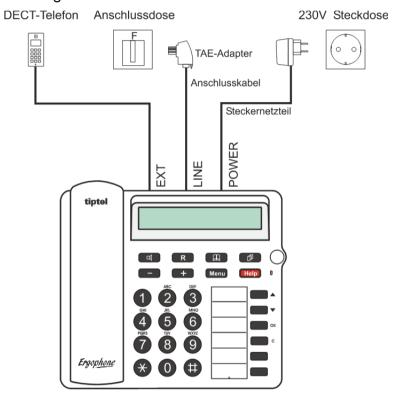
Für diese Anschlussmöglichkeit wird vorausgesetzt, dass die Anschlüsse des Zweitgeräts auf dem mittleren Anschlusspaar des Telefonkabels liegen. Dies ist der Fall, wenn das Zweitgerät die Vorschriften TBR21 oder ETSI ES 203 021 erfüllt.
