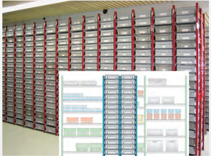
Das T 350 Behälterlagersystem bringt bis zu 70 % Platzeinsparung gegenüber der herkömmlichen Lagerung.
