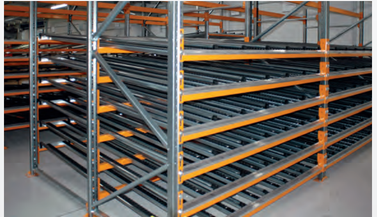
Das Durchlaufregal (FIFO) ermöglicht eine First-in-First-out-Lagerung.
