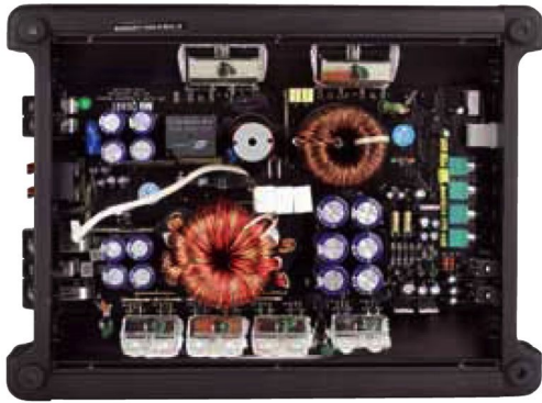
Die NSC 750 ist ein Class-D-Verstärker. Die Verarbeitung ist piekfein
