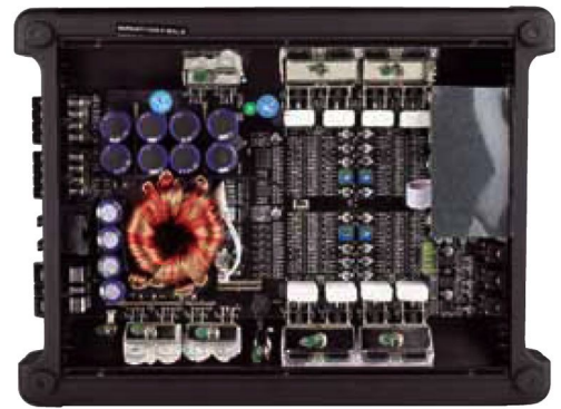
Die Zwei- bzw. Vierkanal sind analoger Art, die dank SMD-Bestückung ins kleine Gehäuse passen
