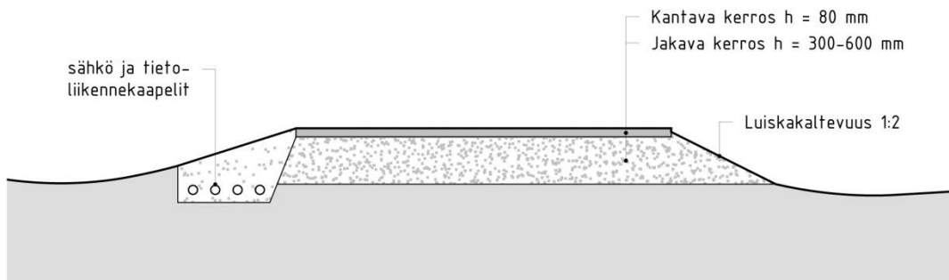
Periaatekuva uuden ja perusparannettavan tien rakenteesta.
