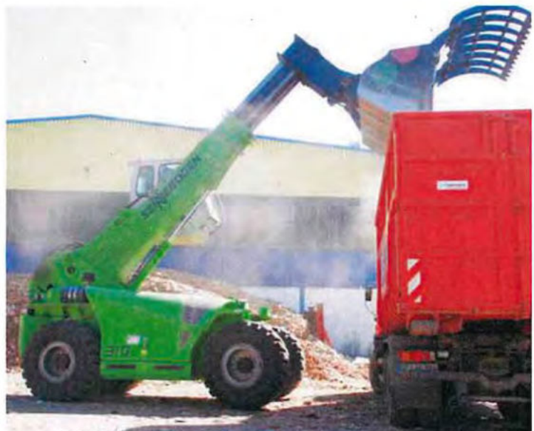
Umlade-Radlader in Abrollcontainer-Lkw mit „Greiferladeschaufel“
