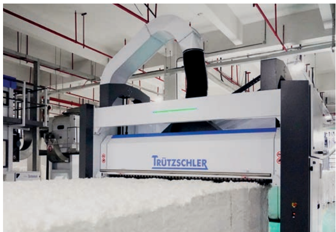
Ein BO-P im Betrieb in einer Fabrik in Wujiang
