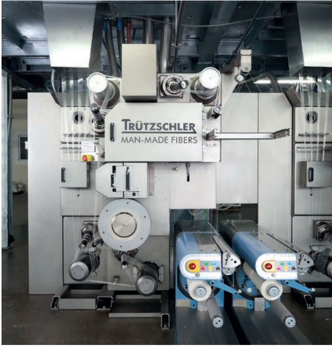
Das 4-fädige BCF-Extrusionssystem MO40
