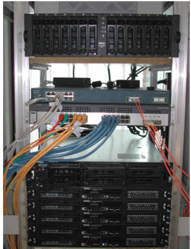
Zur Speicherung von Simulations- Trace-Daten steht ein File-Server mit einer nutzbaren Gesamtplattenkapazität von 3,9 TByte zur Verfügung (5,4 TByte brutto).
