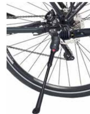
Der FIX 18 T mit verlängertem Kopf bietet aufgrund der tiefere liegenden Mechanik einen deutlich größeren Abstand (ca. 70 mm) zum Achsmittelpunkt des Rades und ermöglicht somit eine ideale Verwendung von Anhängerkupplungen. Durch die spezielle Konstruktion des Ständerkopfes wird dem Radler zusätzlich mehr Fußfreiheit geboten, inkl. Befestigungsmaterial M6 x 25.
