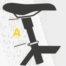
\*\* Die angegebene Aufbauhöhe wird von der Oberkante des Sitzrohres bis zur Unterkante des Sattelgestells gemessen (A). Diese Aufbauhöhe muss unbedingt eingehalten werden, da sonst Rahmen oder Stütze beim Einfedern beschädigt werden.
