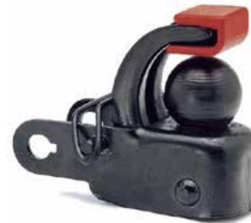
Fahrrad-Anhängerkupplung (Kugelukplung) zur Befestigung am Sattelklemmbolzen, inkl. Rahmen-Stützbock für waagerechte Montage am Zugfahrzeug und inkl. Sicherungssplint, ohne Deichselholm/Pfanne
