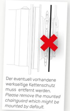
Der eventuell vorhandene werkseitige Kettenschutz muss entfernt werden.
