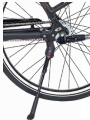
Der FIX 40 T für KSA 40-Aufnahmen hat einen verlängerten Kopf und bietet aufgrund der tieferliegenden Mechanik einen deutlich größeren Abstand zum Achsmittelpunkt des Rades (ca. 70 mm), ermöglicht somit eine ideale Verwendung von Anhängerkupplungen. Durch die spezielle Konstruktion des Ständerkopfes wird dem Radler zusätzlich mehr Fußfreiheit geboten, inkl. 2 x Schraube M6 x 16.
