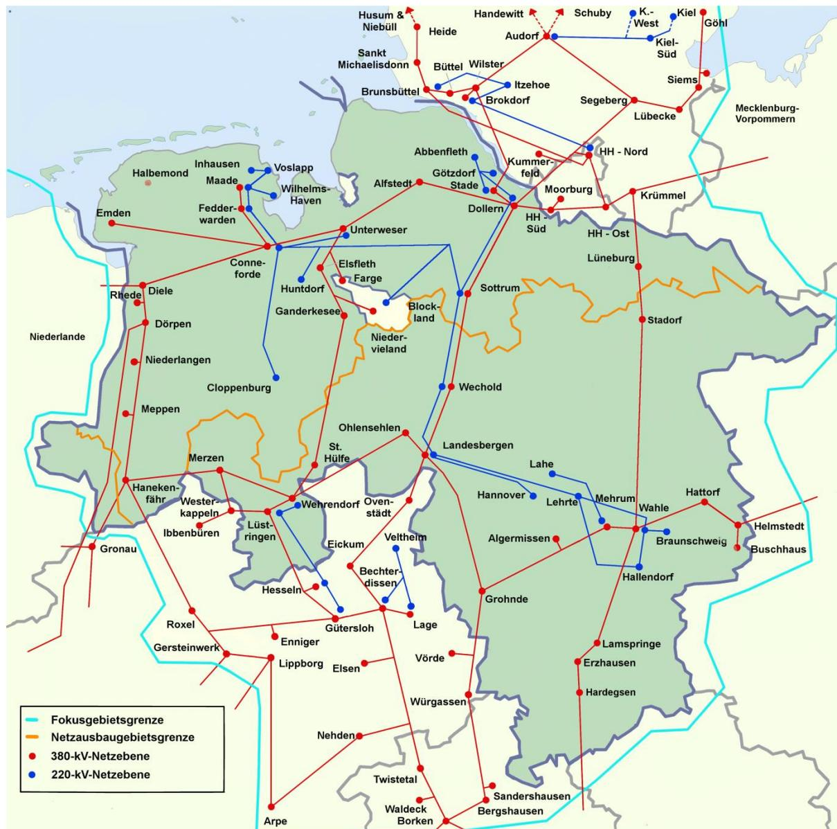
Abbildung 8: Schematische Darstellung des Fokusgebiets mit dem Netz des Planjahres 2021 (Szenarien S4, S5, S6 und S7)
