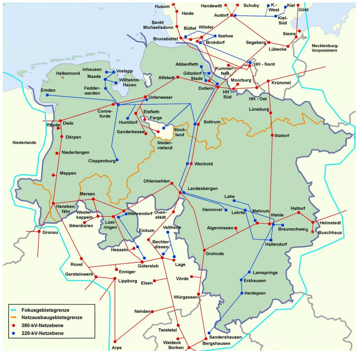
Abbildung 7: Schematische Darstellung des Fokusgebiets mit dem Netz des Planjahres 2019 (Szenarien S1, S2 und S3)
