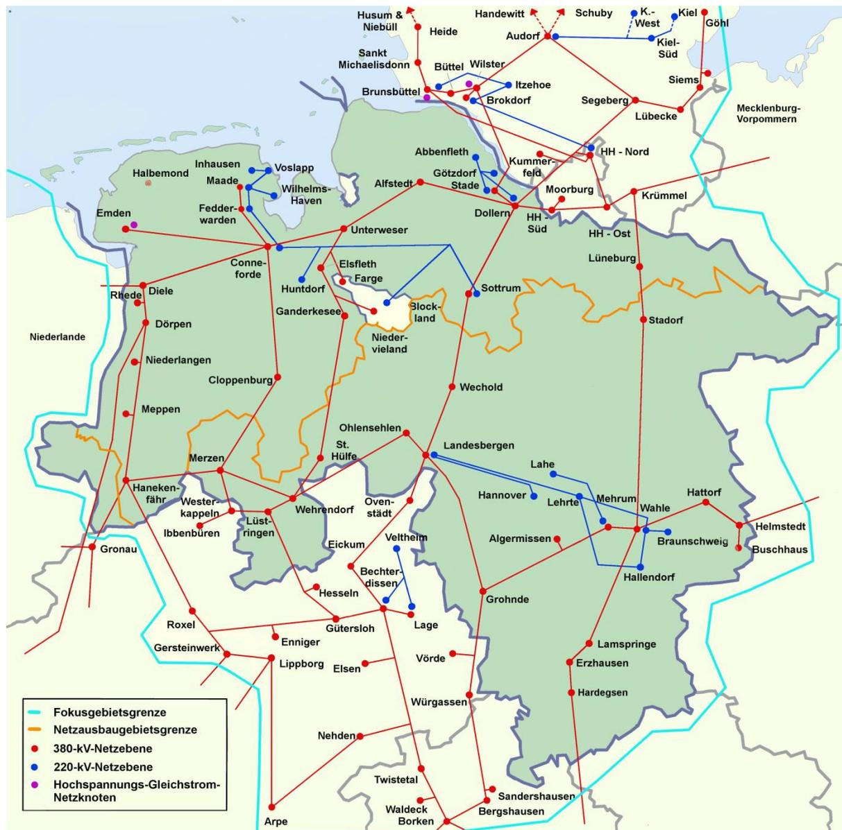
Abbildung 9: Schematische Darstellung des Fokusgebiets mit dem Netz des Planjahres 2025 (Szenarien S8 und S9)
