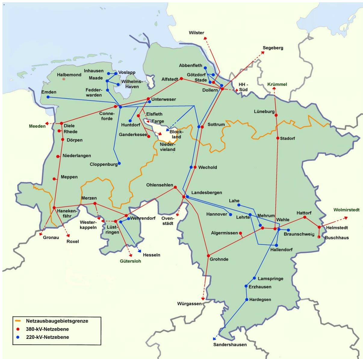
Abbildung 2: Schematische Darstellung der Netzknoten im Übertragungsnetz Niedersachsens; Ausbaustand im Jahr 2015 nach [ÜNB 2016c]
