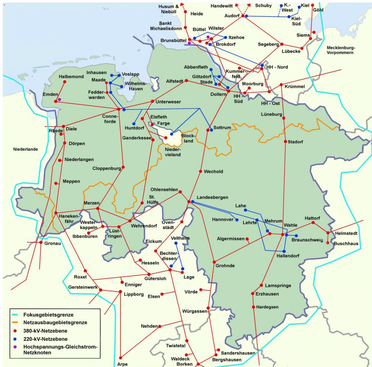
Abbildung 3: Schematische Darstellung des Fokusgebiets mit dem Netz im für das Jahr 2025 erwarteten Ausbauzustand [ÜNB 2016c]
