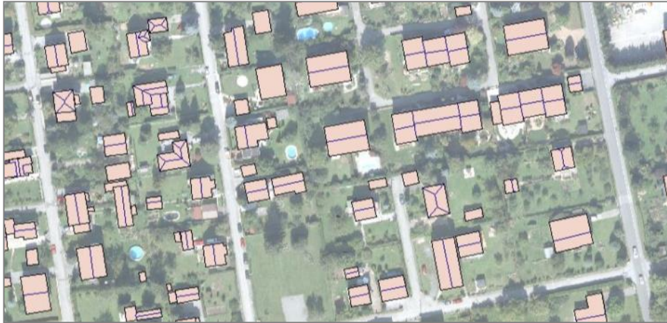
Abbildung 7: Beispiel für fotogrammetrische Daten (in den Hintergrund ist das Orthofoto gelegt, auf dessen Grundlage die fotogrammetrischen Daten basieren); Die Dachflächen, sind als Polygone in Beige dargestellt, die Traufenlinien (in Schwarz) geben Aufschluss über Neigungsänderungen im Bereich der Dachflächen.
