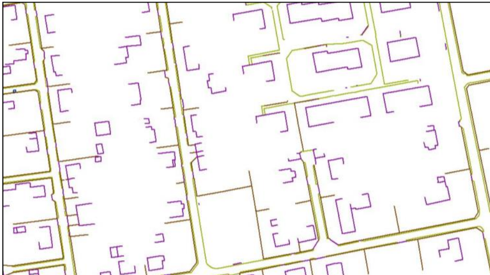
Abbildung 6: Beispiel für die Darstellung von Naturdaten: Zu erkennen sind Gebäudekanten und Zaunmauern im Bereich privater Grundstücke (in Lila) sowie die Abgrenzung der Straßenflächen wie z.B. Gehsteigkanten, Stufen (in Grün).
