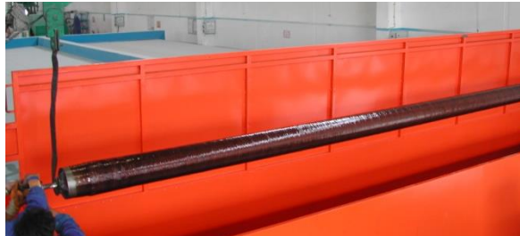
Abbildung 4: Durchlaufofen beim Wickelverfahren
