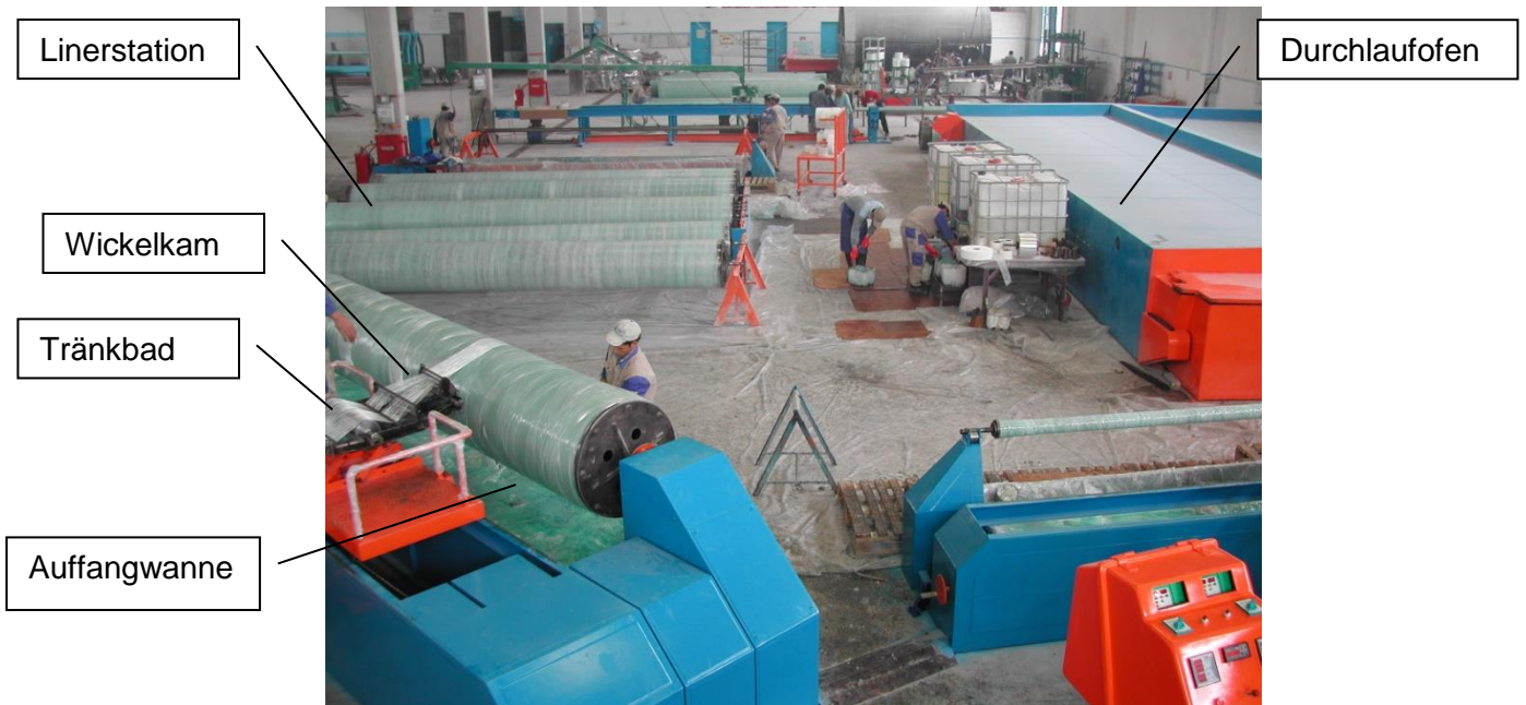
Abbildung 3: Produktion Wickelrohr bei Asut Fiberglass, Mersin, Türkei
