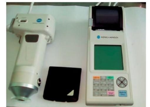
**Fig.3.** Colorímetro triestímulo Konica Minolta CR-400 para la medición del color del exocarpo y mesocarpo en las frutas. Foto tomada por los autores.
