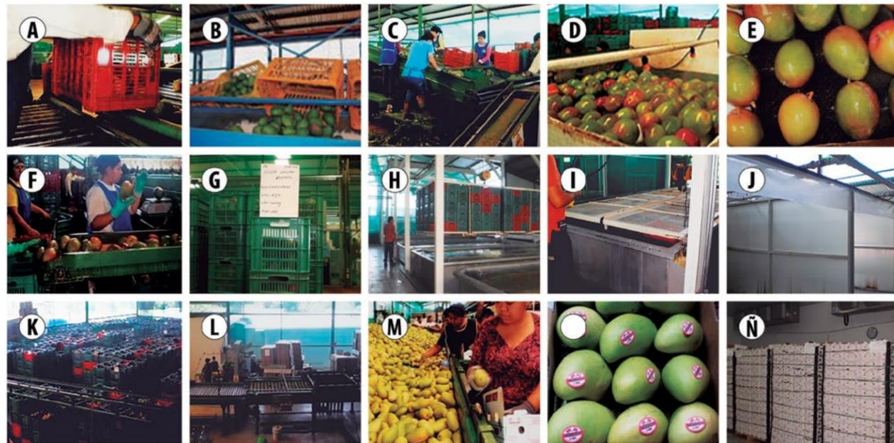
**Fig. 15.** Volteo manual (A) y automático (B), selección (C), lavado (D), escurrido (E), pesaje (F), empaque en cajas plásticas (G), tratamiento cuarentenario (H - I), ducha para el enfriamiento (J), área de espera (K), encerado (L), mesas de empaque (M), empaque en cajas de cartón (N) y frigoconservación (Ñ) en la empacadora Don Reyes, México. Fuente: fotos tomadas por la autora y (B) Brecht *et al.* (2014).
