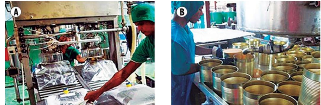
**Fig.12.** Proceso de llenado y envase del puré de mango, (A) escala industrial, (B) mediana o pequeña escala. Fotos tomadas por los autores.
