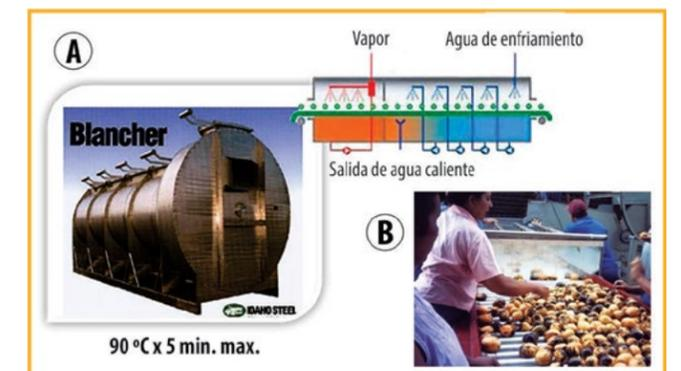
**Fig.6.** Escaldado del mango. (A) escala industrial, (B) mediana o pequeña escala. Fuente: (A) [www.idahosteel.com](http://www.idahosteel.com), (B) foto tomada por los autores.
