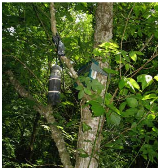
Figura 18.5. Equipo de grabación remota (SongMeter®) instalado en lo alto de la vegetación para grabar especies que frecuentan los estratos arbustivos y arbóreos en el interior de un bosque (Upper Green River Biological Reserve, Kentucky, EE UU). © R. Márquez.
