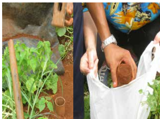
Figura 14.4. Recolección en el campo de la mesofauna del suelo a través del uso del cilindro o nucleador de metal.
