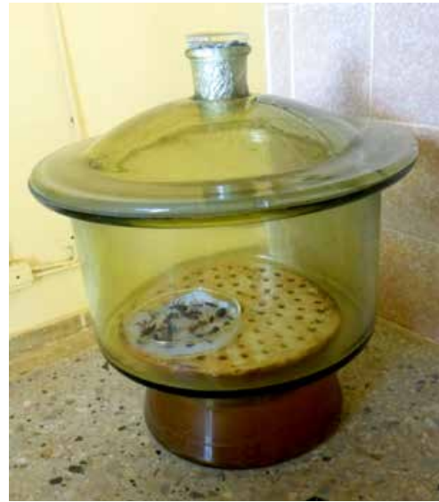
Figura 13.17. Cámara húmeda para ablandar insectos.
