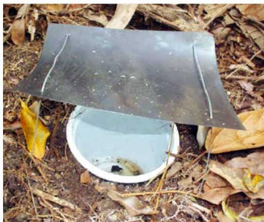
Figura 13.12. Trampa de caída para la captura de insectos con un protector para la lluvia. © A. Hernández.
