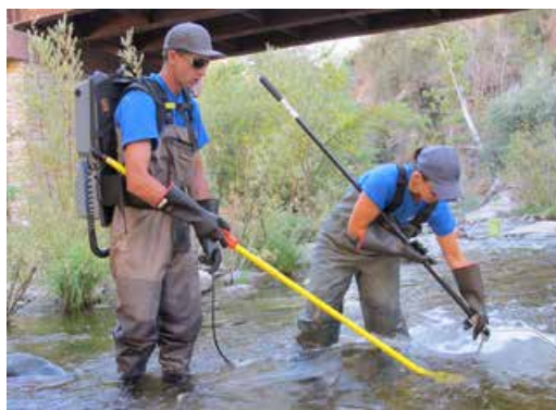
Figura 17.6. Manipulación del equipo de pesca con electricidad por dos recolectores, tomado de www.fishbio.com
