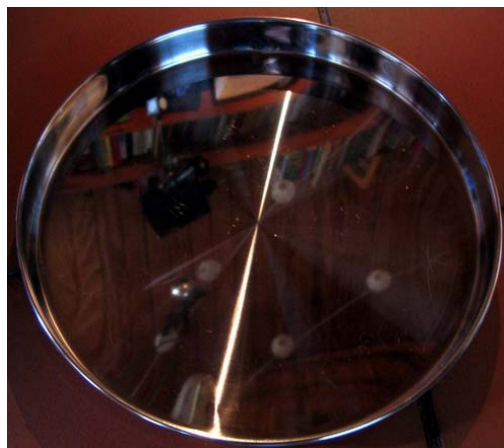
Abb. 2: Lichtbalken auf einem Edelstahltablett. Bei beidäugiger Betrachtung scheint der Lichtbalken aus dem Tablett herauszuragen.
