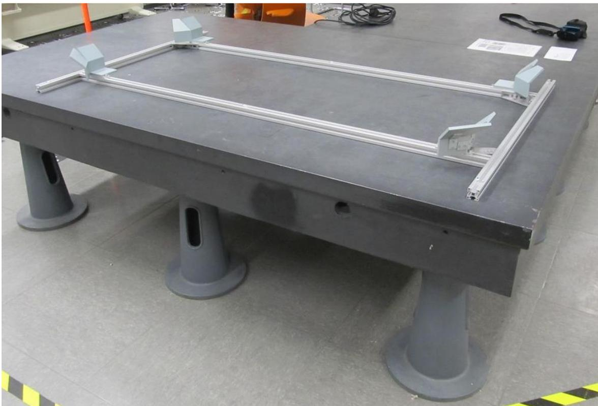
Abb. 6.6: Kalibriervorrichtung des RACER II auf stabilem Metalltisch
