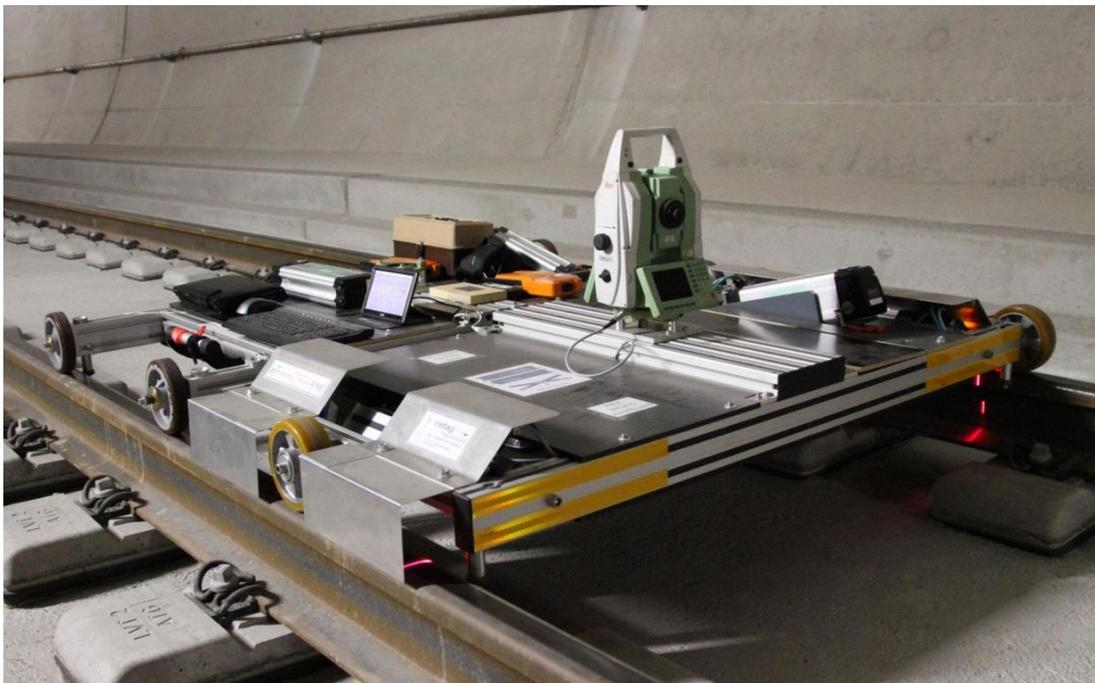
Abb. 3.2: Gleisvermessungssystem RACER II
