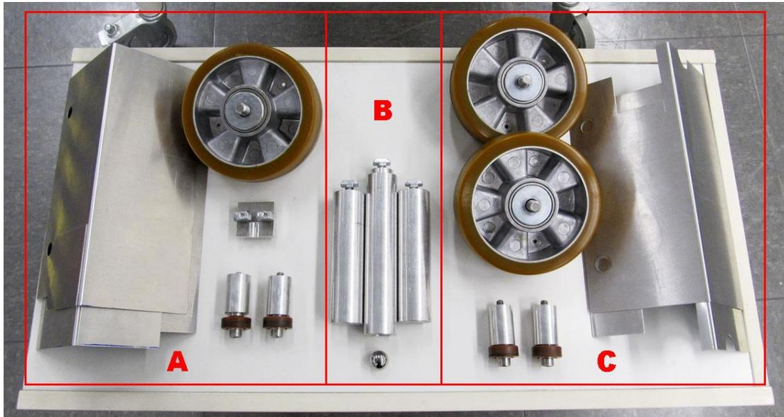
Abb. 6.9: Notwendige Modifikationen für die Kalibrierung von Lasertriangulationssensoren
