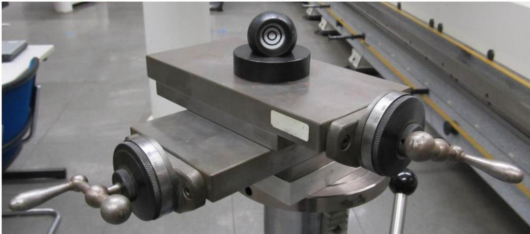
Abb. 6.5: Modifiziertes Corner-Cube-Prisma auf Kreuzschlitten
