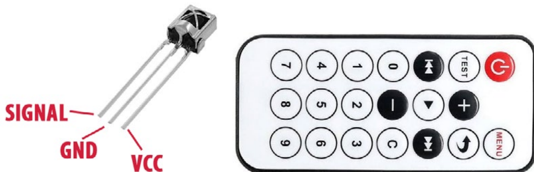
Слика 5.4. Pinout ХХ1838 и изглед даљинског управљача
