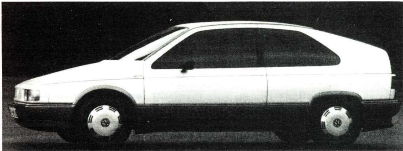
Volkswagen Werke - Auto 2000 - Cx 0,26 - Maître couple S = 1,86 m 2 - Puissance 33 KW (42 CV) - Moteur Diesel 1,2 litre.
