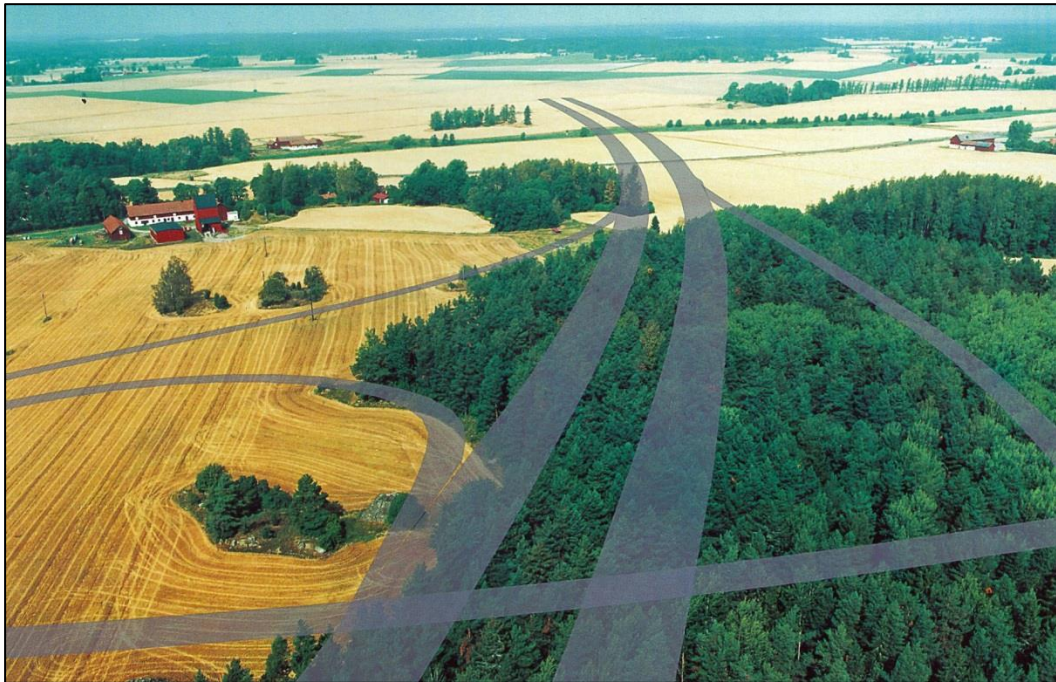
Figur 14. Montage av vägsträckning med Fullerö trafikplats, utfört på flygfoto till Vägverkets MKB 1996. Montaget visar tydligt vilka landskapsvärden och kulturhistoriska värden som påverkats negativt. Flygfoto Metria/Lantmäteriverket, montage Vägverket.
