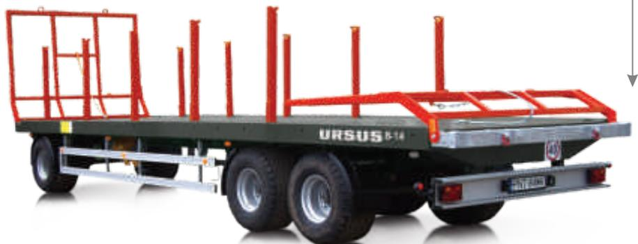
Der Ballenanhänger **B-11, B-15, B-18** und **B-21** verfügt über eine innovative Sicherung der Vorder- und Heckwand. Zwei im Transportgestell eingebauten Schutzseilen verhindern Transportschäden an in der Folie umgewickelten Silageballen. Der Boden besteht aus einer 3 mm starken, einteiligen Platte aus hochwertigem und abriebfestem Stahl. Zur Zusatzausstattung der Plattform gehören: Werkzeugkasten 45l, einklappbarer seitlicher Auffahrerschutz, Rungen.
