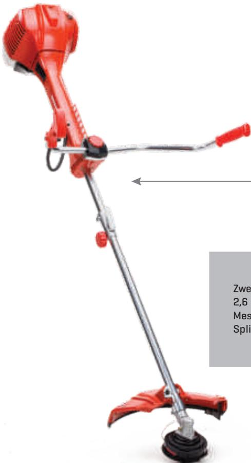
Zweitakt-Ottomotor, Hubraum: 50,8 cm<sup>3</sup>, Leistung max. 2,6 PS, Zündkerze: BOSCH, Fadenschnittbreite: 42 cm, Messer-Arbeitsbreite: 25,5 cm, Anti-Vibrations-System, Split Schaft, Profi-Schultertragegurt, Gewicht: 10kg.
