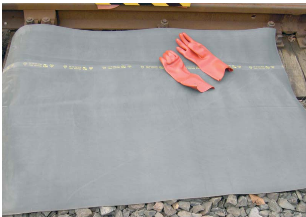
Abbildung 4: Standortisolierung mit Gummimatte und Gummihandschuhen nach DIN VDE 0680-1.
