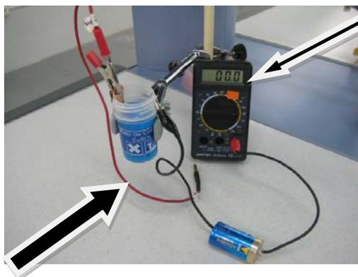
9) Conecte la clavija al amperímetro (en la toma "COM") y ponga el cronómetro en marcha inmediatamente o mire la hora exacta en su reloj y anótela.
