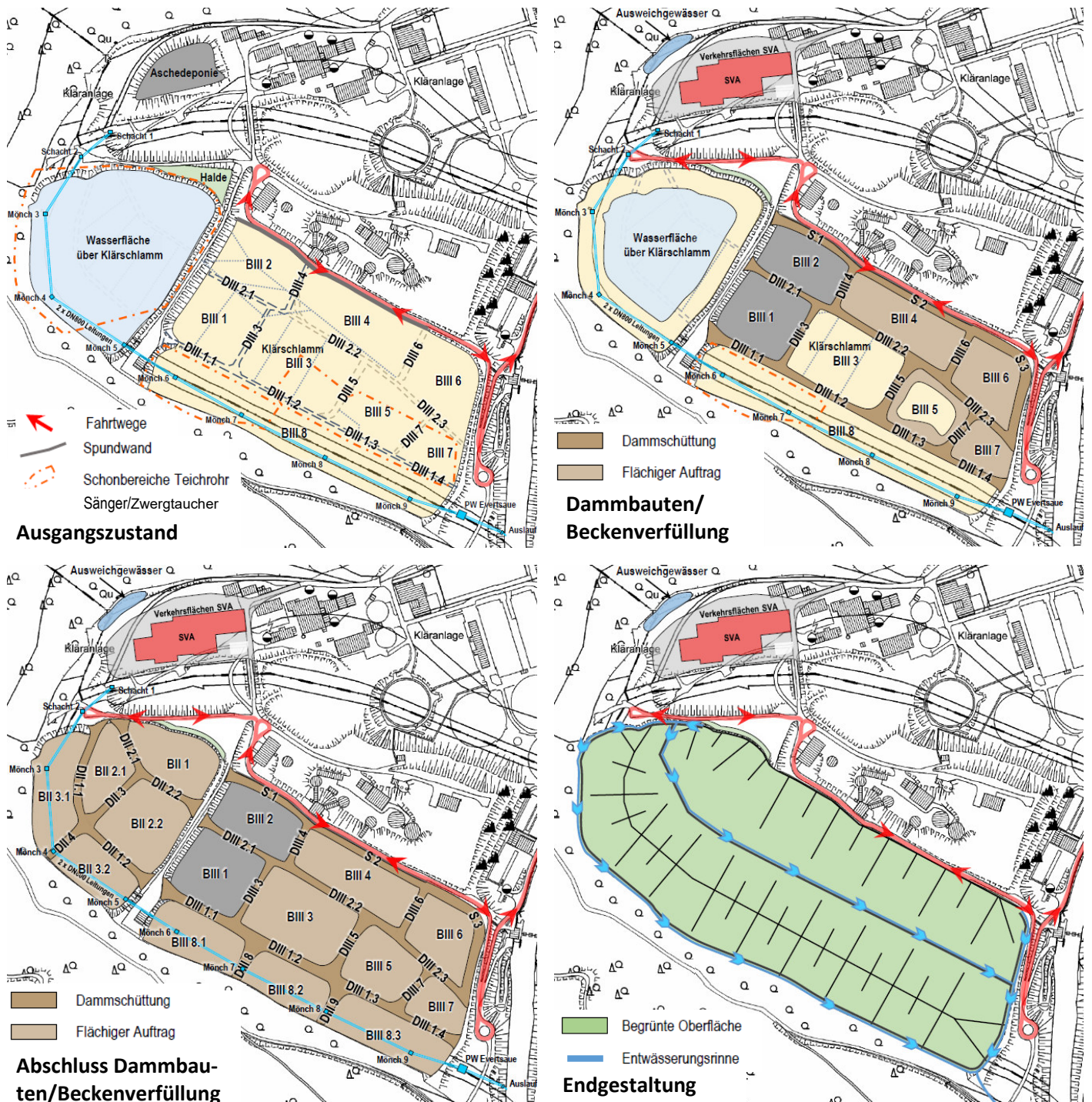
Abb. 7: Phasen der Übererdung der Klärschlammflächen (Auszug aus Anlage 4).
